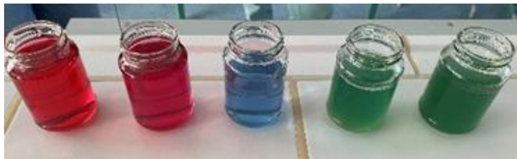
Hier sieht man Rotkrautsaft gemischt mit Zitronensaft, Essig, Wasser, Waschmittel und Waschsoda. Links sind die Lösung sauer, in der Mitte neutral und rechts ist sie basisch.
